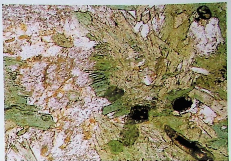
Fig. 19 Hornblenda com núcleo mais claro e sobrecrescimentos mais escuros prismáticos a aciculares. Polarizadores paralelos. Lado maior: 1.04mm.
