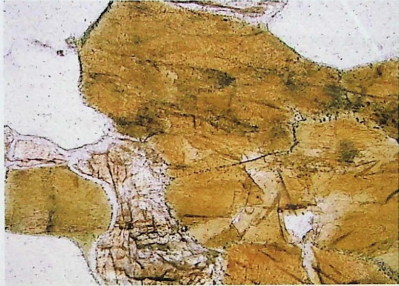
Fig. 8 Hornblenda com aparentes exoluções de opacos. Polarizadores paralelos. Lado maior: 1,3mm.
