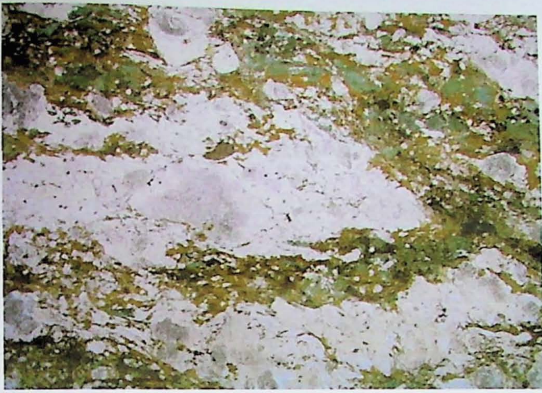
Fig.6 Bandamento em gnaiss tonalítico. Polarizadores paralelos. Lado maior: 10,4 mm.
