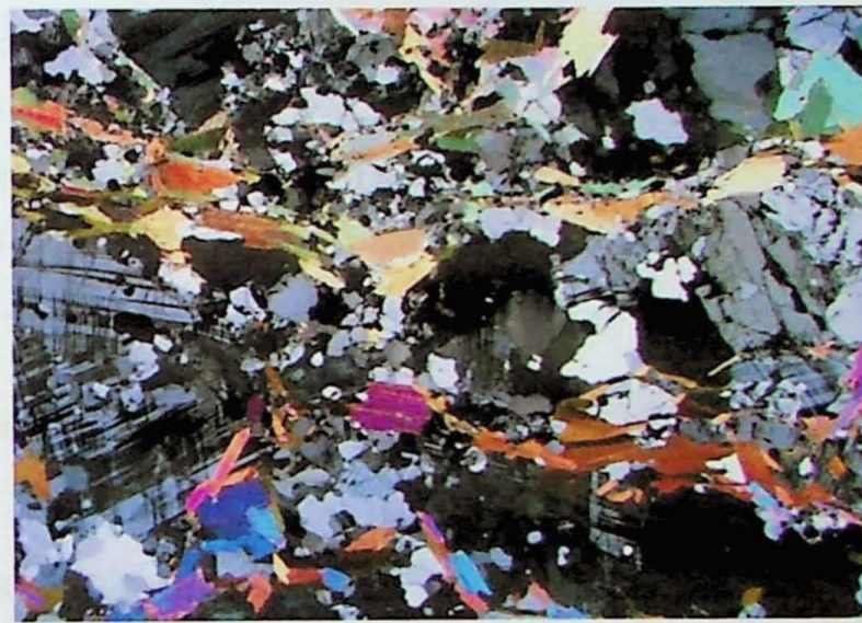
Fig. 27 Aspecto geral dos Bt-Ms gnaisses. Polarizadores cruzados. Lado maior: 10,4mm
