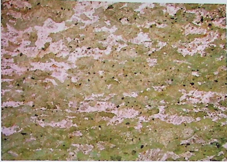
Fig. 18 Aspecto geral dos anfibolitos migmatíticos. Polarizadores paralelos. Lado maior: 10,4mm
